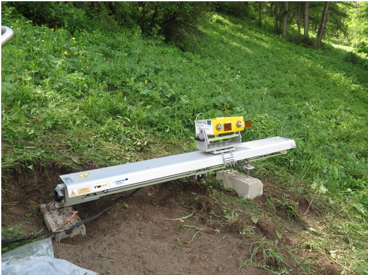
Installation du GBInSAR sur site du versant opposé au glissement de terrain du "Pas de l'Ours" (Hautes-Alpes)
