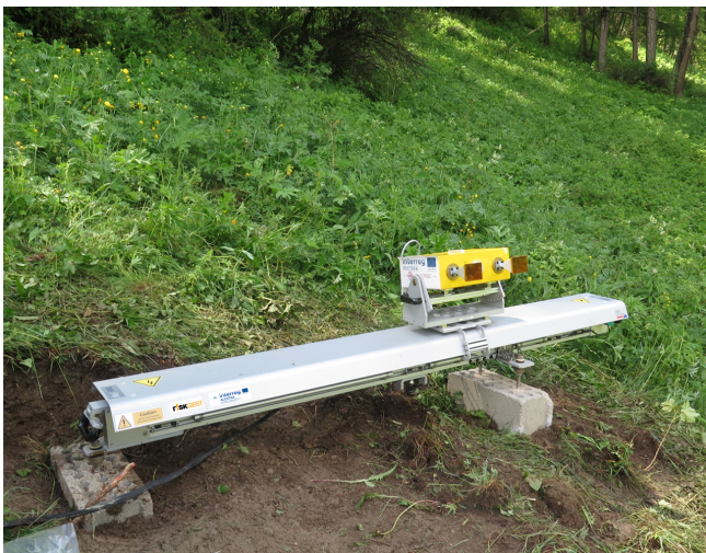
Installation du GBInsar sur site du versant opposé au glissement de terrain du Pas de l'Ours (Hautes-Alpes) © BRGM
