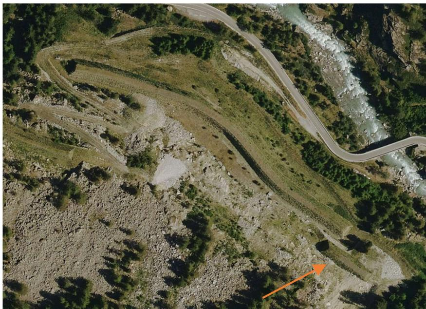
Il rilevato in oggetto si posiziona a sud della SR 47 (Cogne). Il sistema di protezione è composto da un rilevato di lunghezza maggiore e da uno di lunghezza minore. La presente scheda si riferisce al rilevato di lunghezza minore (freccia).
